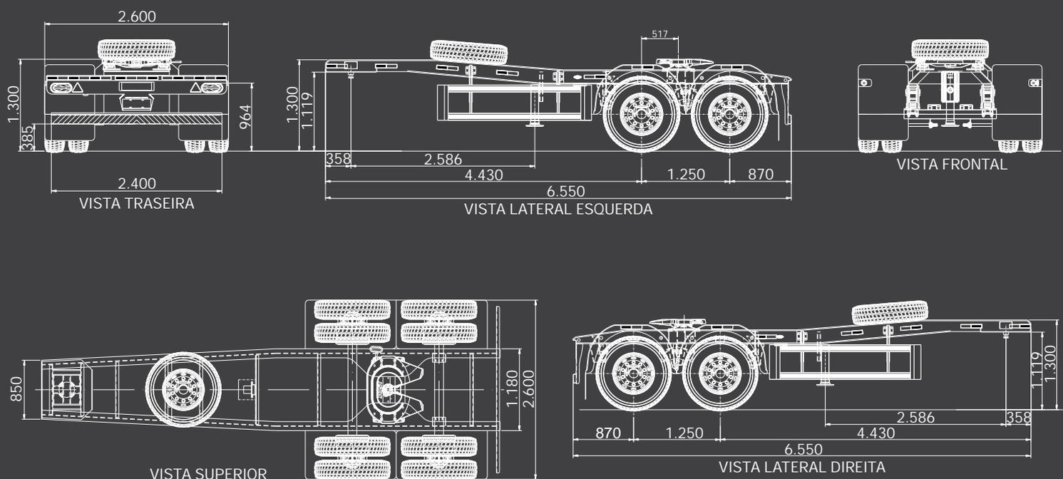
Entre-eixos de 1.240mm – PBT de 25.500kg
